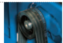
Antriebssystem – hocheffizienter, betriebssicherer Keilriemenantrieb
